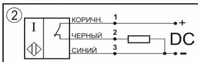
Схема соединения Нормально-замкнутый контакт
