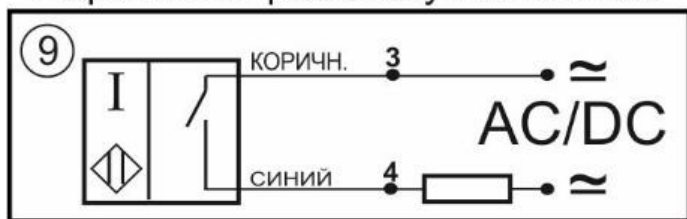
Схема соединения Нормально-разомкнутый контакт
