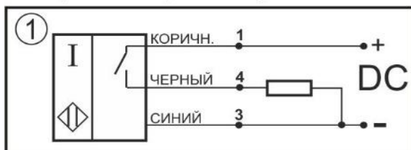
Схема соединения Нормально-разомкнутый контакт
